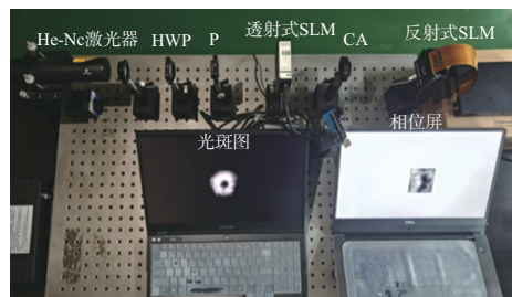
图5 涡旋光束湍流实验光路实物图
