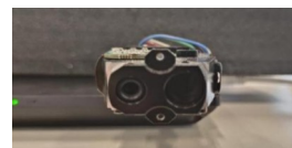
图 2 口内三维测量设备核心光学结构
