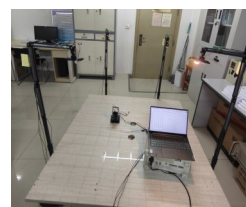
图13 可见光室内定位实验平台
